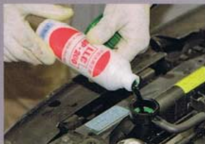
▲フラッシング後にLLC再生強化液「SP-200」を投入。劣化してしまう消泡剤や酸化防止剤などを中心に構成されており、防錆効果や消泡効果を再生する
