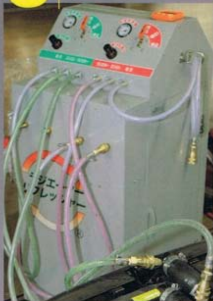
▲作業はラジエーターリフレッシャーという機械で行う。スーパーオートバックス新小岩をはじめとする一部量販店や、ガソリンスタンドなどに設置されている
