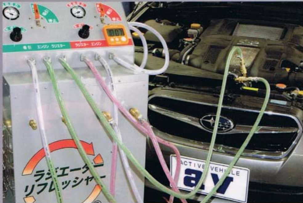
▲毎分4リットの冷却水を循環させ、装置によって発生する超音波が内部を洗浄。ラジエーターコアやウォータージャケットなどのスメリがなくなり、新車時の冷却性能に戻る
